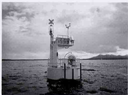
関根浜沖合に設置された係留式モニタリングポスト
